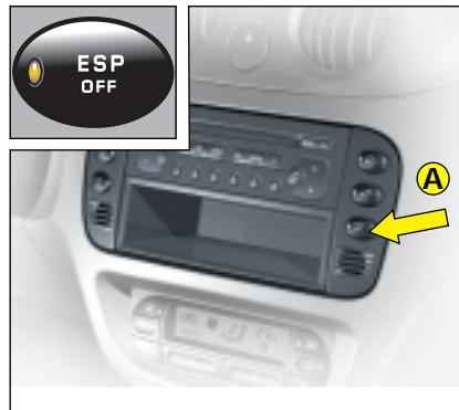
Данная система непосредственно связана с системой ABS и дополняет ее. В случае отклонения автомобиля от траектории движения, задаваемой водителем, система ESP автоматически подтормаживает одно или несколько колес, а также воздействует на работу двигателя, чтобы скорректировать траекторию движения автомобиля.
