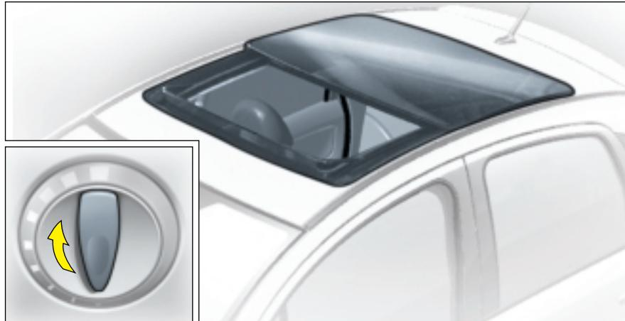
Люк с электроприводом управляется в ступенчатом режиме, поворотная рукоятка управления расположена между солнцезащитными козырьками на потолочной обивке и имеет 9 положений установки.
