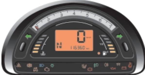
Бортовой компьютер выдает **4** типа информации на дисплее в верхней части комбинации приборов.
