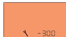
Через 5 секунд после включения зажигания на дисплее ровным светом горит изображение гаечного ключа, а также отображаются данные об общем пробеге автомобиля.
