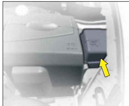
Предохранители в моторном отсеке
